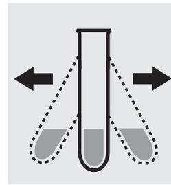
Agitar intensamente el tubo para disolver la sustancia sólida.
