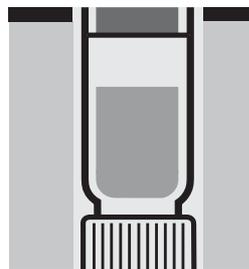
Calentar la cubeta de reacción **en posición invertida** en el termostator 2 horas a 120 °C.
