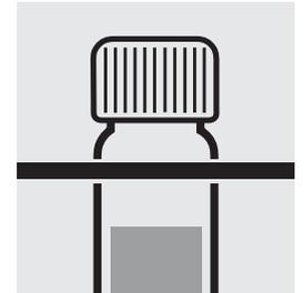
Sacar la cubeta del termostator, dejarla enfriar a temperatura ambiente en un soporte para tubos de ensayo.
