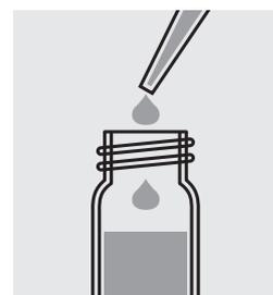
Añadir 2,0 ml **Vario Sodium hydroxide 1.54N** con una pipeta, cerrar la cubeta con el tapón roscado y mezclar.
