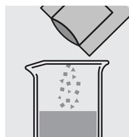
Añadir el contenido de un sobresito de **Vario Molybdenum HR 3 F25 ml** y disolver el polvo revolviendo la solución.
