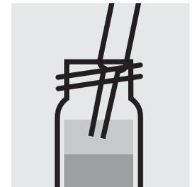
Mediante una pipeta Pasteur, aspirar la capa clara superior.
