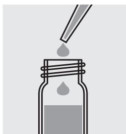
Agregar con la pipeta 0,5 ml de la muestra, cerrar la cubeta con el tapón roscado y mezclar enérgicamente durante 30 s, como mínimo. Puede suceder que una pequeña cantidad de sólido no se disuelva.
