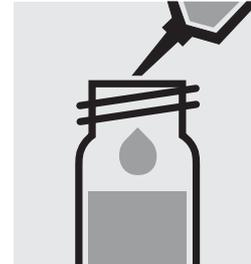
Añadir 2,0 ml de la muestra con la pipeta, cerrar con la tapa roscada y mezclar. **¡Atención, la cubeta se calienta!**
