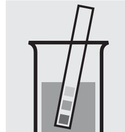
Comprobar el valor del pH de la muestra, intervalo necesario: pH 7,0–9,5. En caso necesario, corregir el valor del pH añadiendo gota a gota solución diluida de hidróxido sódico o de ácido sulfúrico.
