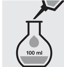
Pipetear 4,0 ml de la muestra en un matraz aforado de 100 ml, llenar con agua destilada hasta la señal de enrase y mezclar bien.
