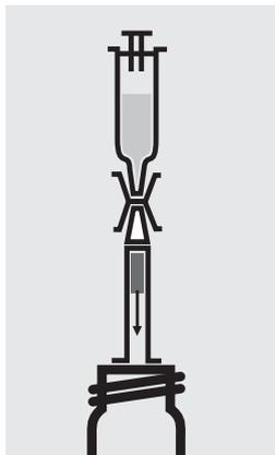
Colocar la pieza de conexión en el extremo inferior de la columna. Transferir a una cubeta vacía (cubetas vacías, art. 250621) el carbón de la columna con 10 ml de **AOX-5** mediante una jeringa de plástico.
