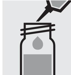
Añadir 1,0 ml de la muestra con la pipeta, cerrar la cubeta con la tapa roscada y mezclar.
