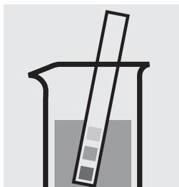
Comprobar el valor del pH de la muestra, intervalo necesario: pH 4–13. En caso necesario, corregir el valor del pH añadiendo gota a gota solución diluida de hidróxido sódico o de ácido sulfúrico.
