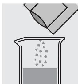
Añadir el contenido de un sobresito de **Vario Molybdenum HR 2 F25 ml** y disolver el polvo revolviendo la solución.
