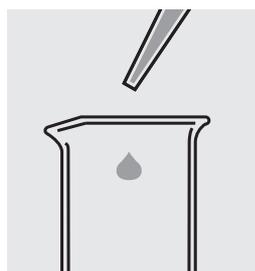
Llenar con una pipeta 25,0 ml de la muestra en un envase vacío.
