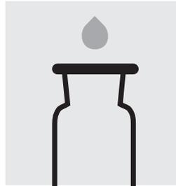
Llenar 2 frascos de reacción oxígeno con **muestra preparada** y 2 perlas de vidrio hasta derramar. Cerrar sin que queden burbujas de aire con tapón de vidrio biselado.
