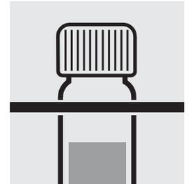
Sacar la cubeta del termostato, dejarla enfriar a temperatura ambiente en un soporte para tubos de ensayo.
