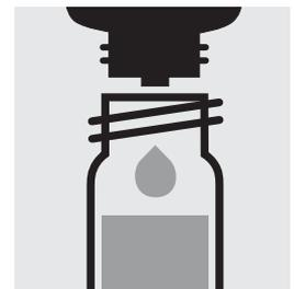
Añadir 5 gotas de **AOX-4**, cerrar con la tapa roscada y mezclar. Dejar sedimentar el carbón. solución sobrenadante: **muestra preparada**
