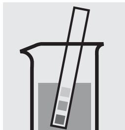
Comprobar el valor del pH de la muestra, intervalo necesario: pH 1–13.
