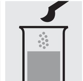
Añadir 1 microcuchara verde rasa de **Cd-3** al tubo de ensayo y disolver la sustancia sólida.
