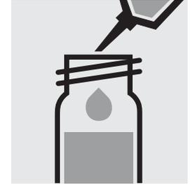
Añadir 0,50 ml de **AC-2** (de test Capacidad de ácido, art. 252087) con la pipeta, cerrar la cubeta con la tapa roscada y mezclar.
