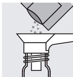
Añadir el contenido de un sobresito de **VARIO TN Persulfate Rgt.** en una cubeta de disgregación **TN Hydroxide LR.**
