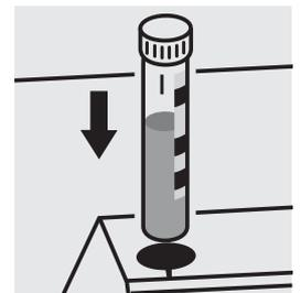
Colocar la cubeta en el compartimento para cubetas. Hacer coincidir la raya de marcado de la cubeta con la marca de fotómetro.
