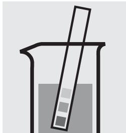
Comprobar el valor del pH de la muestra, intervalo necesario: pH 3–10. En caso necesario, corregir el valor del pH añadiendo gota a gota solución diluida de hidróxido sódico o de ácido sulfúrico.
