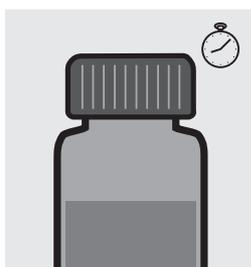
Dejar reposar como mínimo durante 2 horas a una temperatura de +4°C para que se produzca la extracción.
