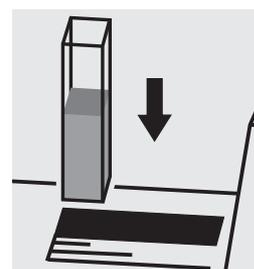
Colocar la cubeta en el compartimento del fotómetro e iniciar la medición.
