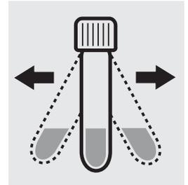
Agitar intensamente la cubeta para disolver la sustancia sólida.
