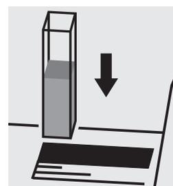
Colocar la cubeta en el compartimiento del fotómetro e iniciar la medición.
