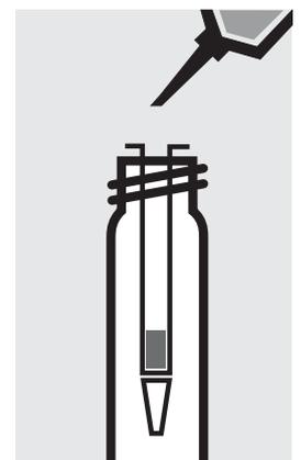
Separar la columna del despósito, hacer recorrer completamente 3 veces 1 ml cada vez de **AOX-3** a través de la columna. Desechar la solución de lavado.
