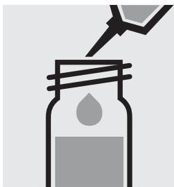
Pipetear 3,0 ml de la muestra revuelta en una cubeta de reacción.
