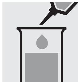
Pipetear 5,0 ml de **NH<sub>4</sub>-1** en un tubo de ensayo.
