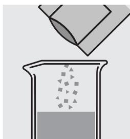
Añadir el contenido de un sobresito de **Vario Oxyscav 1 RGT** y disolver el polvo revolviendo la solución.
