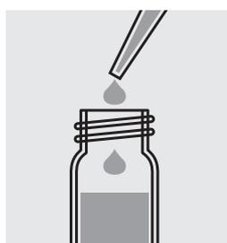
Llenar con una pipeta 2,0 ml de la muestra en una cubeta de reacción.
