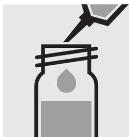
Tomar de la cubeta de disgregación 7,0 ml de la **muestra preparada** mediante una pipeta de vidrio (sin carbón) y pipeta en la cubeta de reacción, cerrar con la tapa roscada y mezclar.
