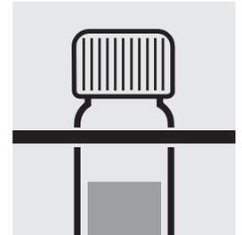
Sacar la cubeta del termorreactor, dejarla enfriar a temperatura ambiente en un soporte para tubos de ensayo.
