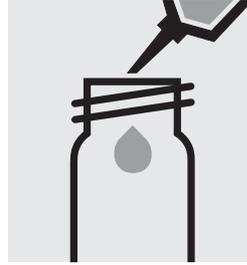
Pipetear 4,0 ml de **AC-1** (de test Capacidad de ácido, art. 252087) en una cubeta redonda.
