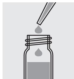
Añadir con una pipeta 2,0 ml de la muestra preparada en una cubeta de reacción **TN Acid LR/HR (Reagent C)** y cerrar la cubeta con la tapa roscada.
