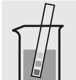
Comprobar el valor del pH de la muestra, intervalo necesario: pH 4,5–8,0. En caso necesario, corregir el valor del pH añadiendo gota a gota solución diluida de hidróxido sódico o de ácido sulfúrico.
