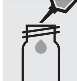
Pipetear 5,0 ml de la muestra en una cubeta de reacción, cerrar con la tapa roscada y disolver la sustancia sólida.
