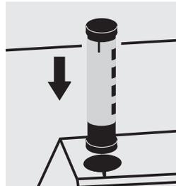
Seleccionar el método con el AutoSelector 2,0–75,0 mg/l de NH<sub>4</sub>-N.
