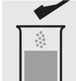
Añadir 1 cuchara dosificadora verde de **Cu-1** y disolver la sustancia sólida.
