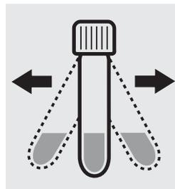
Agitar intensamente la cubeta para disolver la sustancia sólida.
