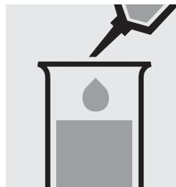
Añadir 5,0 ml de la agua destilada y 0,50 ml de la muestra con la pipeta y mezclar.
