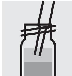
Con una pipeta Pasteur, aspirar la capa clara superior coloreada y secar sobre **sulfato sódico anhidro p. a.**
