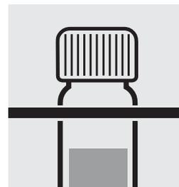
Sacar la cubeta del termostato, dejarla enfriar a temperatura ambiente en un soporte para tubos de ensayo.
