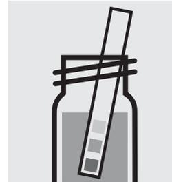
Comprobar el valor del pH de la muestra, valor necesario: pH 3,0. En caso necesario, corregir el valor del pH añadiendo gota a gota solución diluida de hidróxido sódico o de ácido sulfúrico.
