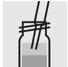
Con una pipeta Pasteur, aspirar la capa clara superior coloreada y secar sobre **sulfato sódico anhidro p. a.**
