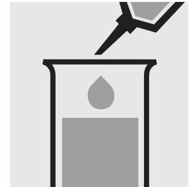
Añadir 5,0 ml de la muestra con la pipeta y mezclar.
