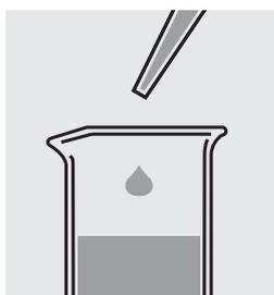
Añadir con una pipeta 0,5 ml **Vario DEHA 2 RGT** y mezclar.
