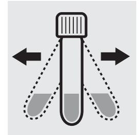
Agitar intensamente la cubeta para disolver la sustancia sólida.
