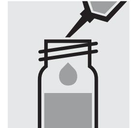
Añadir 5,0 ml de **Zn-6** (art. 06146, isobutilmetilcetona) con la pipeta y cerrar con la tapa roscada el tubo.
