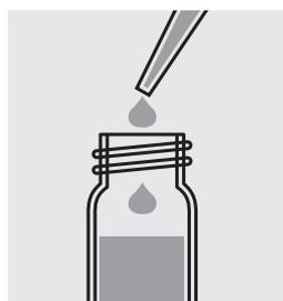
Llenar con una pipeta 5 ml de la muestra en una cubeta de reacción.
