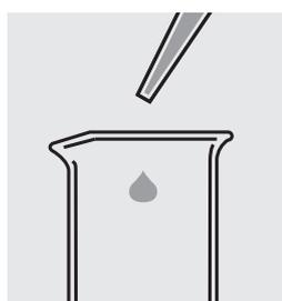
Llenar con una pipeta 10,0 ml de la muestra en un envase vacío.
