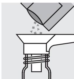
Añadir el contenido de un sobresito de **VARIO TN Persulfate Rgt.** en una cubeta de disgregación **TN Hydroxide HR.**
