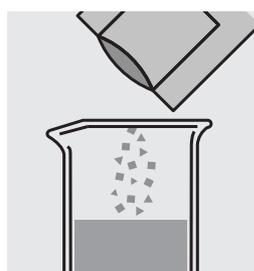
Añadir el contenido de un sobresito de **Vario Molybdenum HR 1 F25 ml** y disolver el polvo revolviendo la solución.
