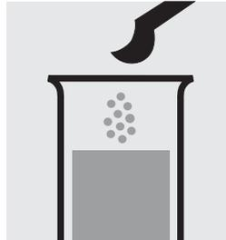
Añadir 1 microcuchara azul rasa de **Al-1** al tubo de ensayo y disolver la sustancia sólida.
