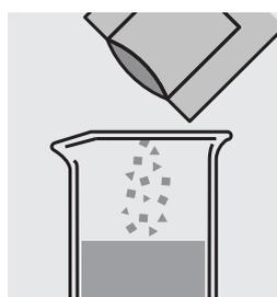
Agregar el contenido de un sobresito de **VARIO Chlorine FREE-DPD F25** y disolver el polvo revolviendo la solución.
