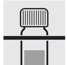
Sacar la cubeta del termo-reactor, dejarla enfriar a temperatura ambiente en un soporte para tubos de ensayo.
