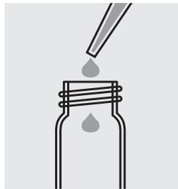
Lenar con una pipeta 10,0 ml de la muestra en una cubeta vacía.
