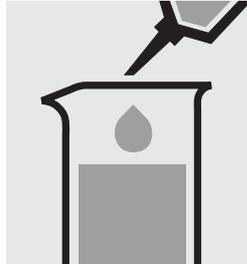
Añadir 1 ml de **ácido clorhídrico 1 mol/l p. a.** con la pipeta y mezclar.
