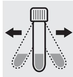
Agitar intensamente la cubeta para disolver la sustancia sólida y dejar en reposo durante **1 minuto**.
